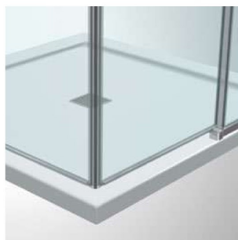
installazione senza profilo diga inferiore, a discrezione dell'installatore - la tenuta all'acqua è ridotta e potrebbe non rispettare le performance richieste dalla normativa EN14428
